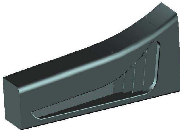
FIGURA 4. RAPPRESENTAZIONE 3D DELLA PRESA D'ARIA LATERALE.
